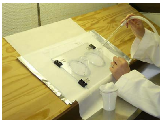
Figure 3. Cone bioassay on long-lasting insecticidal mosquito net (courtesy of Dr Vincent Corbel, Institut de Recherche pour le Développement (IRD), Montpellier, France).
