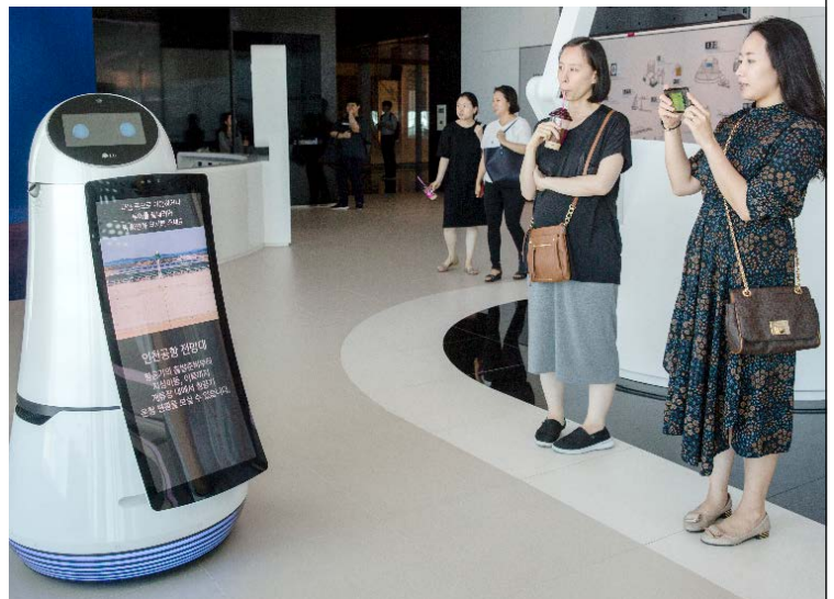
Besøgende i Incheon International Airport i Seoul kommunikerer med Guide Robot, der kan genkende sprog – engelsk, kinesisk, koreansk og japansk. Den kan også scanne boardingkort og vise de rejsende hen til den rigtige afgangshal.
