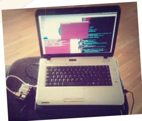
Mit udviklingssetup består af en Odroid U3, forbundet til min laptop med et krydskabel. Man kan komme langt med virtuelle maskiner, men rigtig hardware opfører sig ofte lidt anderledes, så det er vigtigt at teste med hardware.
