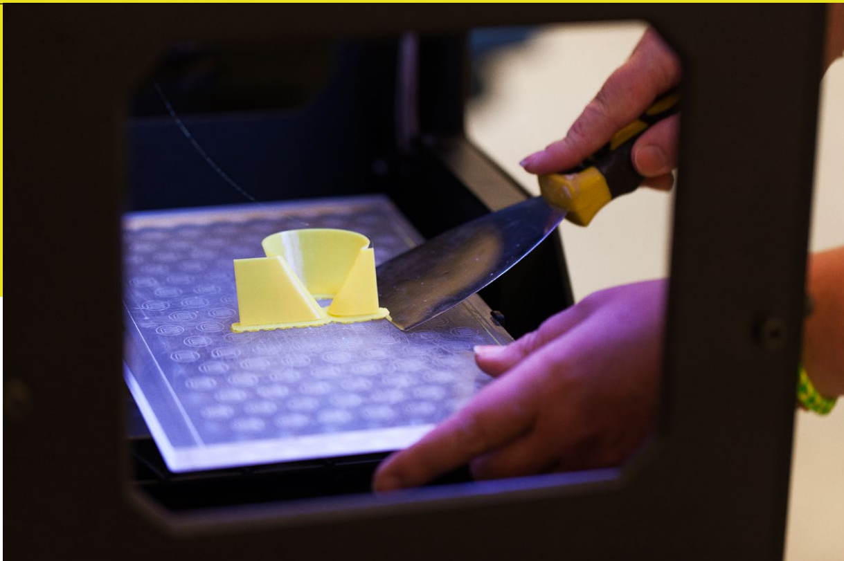
FDM (Fused Deposit Modelling), hvor emnet skabes ved at printe et plastmateriale (filamentet) lag på lag, er stort set enerådende på det private 3D-printermarked.
