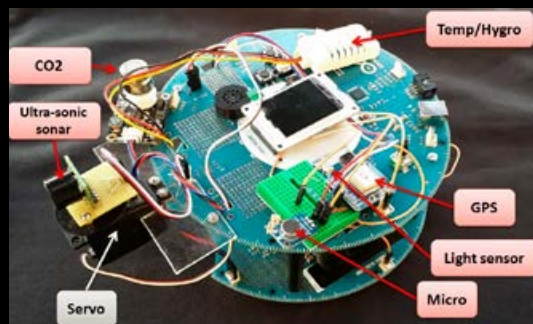
Den franske Arduino-robot ArduWellBeingBot indsamler miljødata og overfører dem via Bluetooth til Android-mobiltelefoner.
