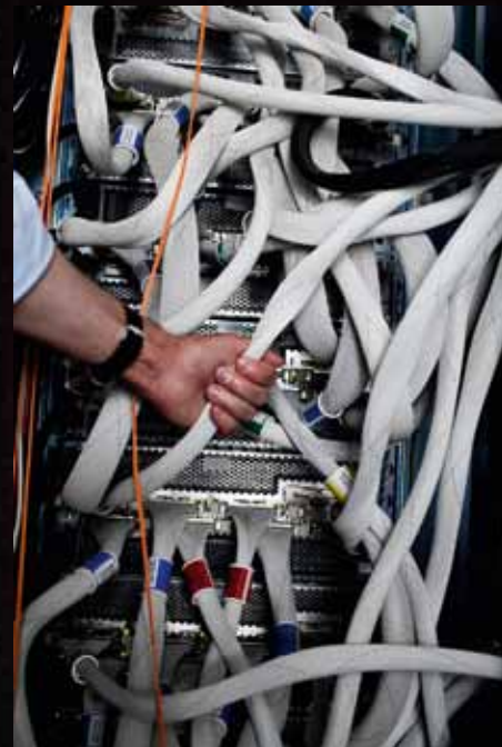
Noderne i supercomputeren kommunikerer indbyrdes over NUMALink, der har to envejsdataforbindelser på hver 7,5 GB/s. Foto: Lars Bertelsen.
