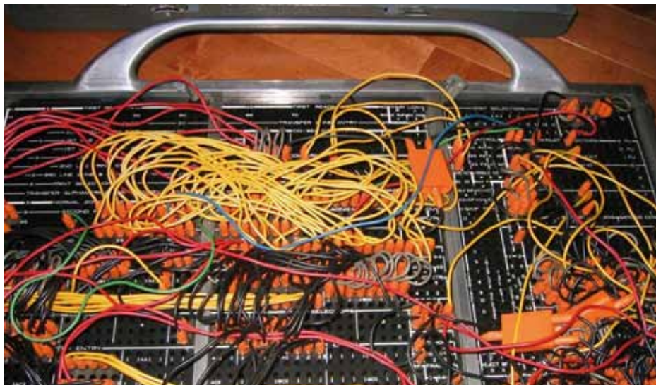
Teknologi fra 1948, men stadig alive og kicking. IBM-regneenheden fungerer gennem direkte krydsfelt-baseret programmering.
