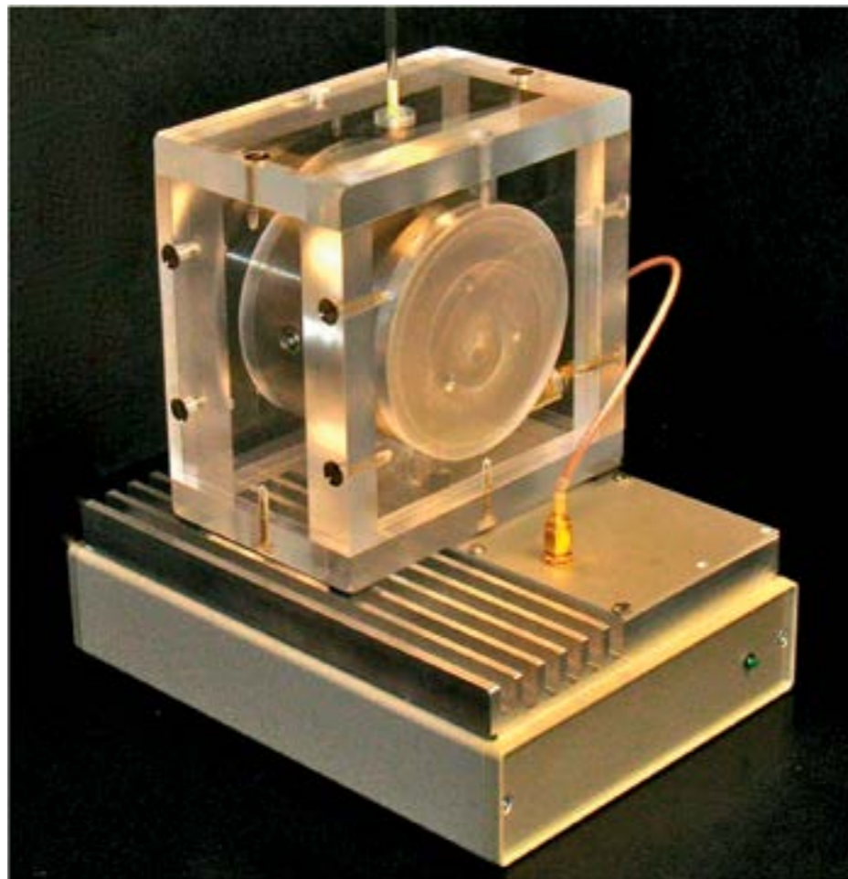
Sådan ser verdens mindste MR-skanner ud. Den kan detektere kræftceller i en lille vævsprøve. Resultatet af analysen sendes trådløst til en smartphone. Foto: C. Min, H. Lee og R. Weissleder.
