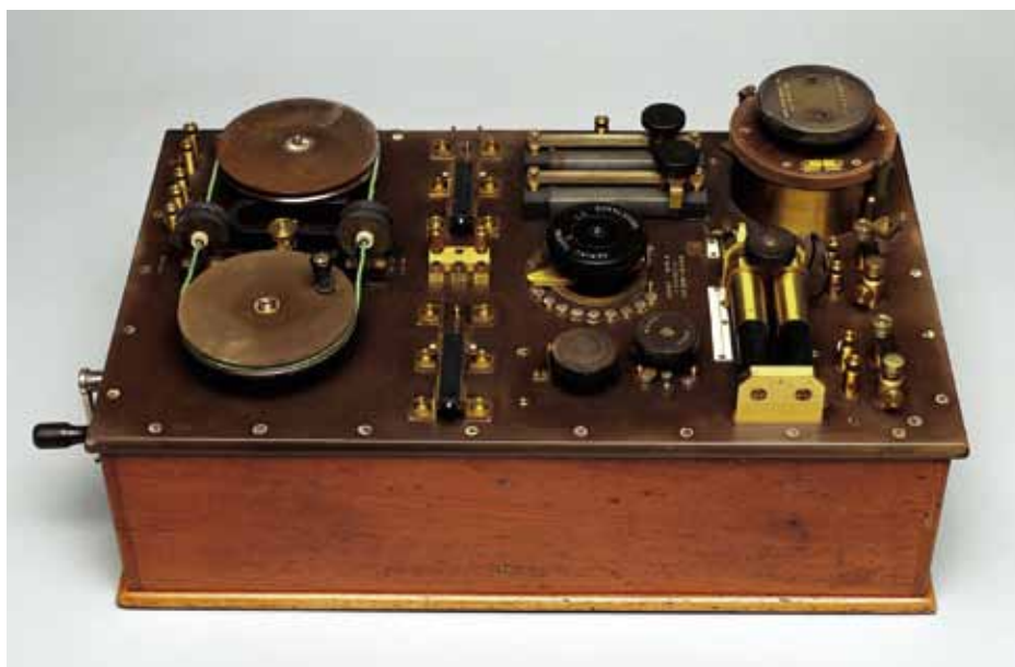
Marconi opfandt denne modtager med magnetisk detektor. Foto: Post & Tele Museum.
