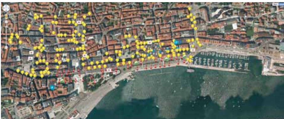
De fleste sensorer er placeret i centrum af byen. De gule prikker er lys- og temperatursensorer, der på sigt blandt andet kan bruges til at spare strøm i gadelamperne.
