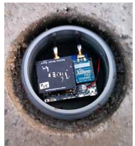
Parkeringsensoren består af en ferromagnetisk sensor, der registrerer ændringer i magnetfeltet på parkeringspladsen, når biler ankommer og tager af sted.
