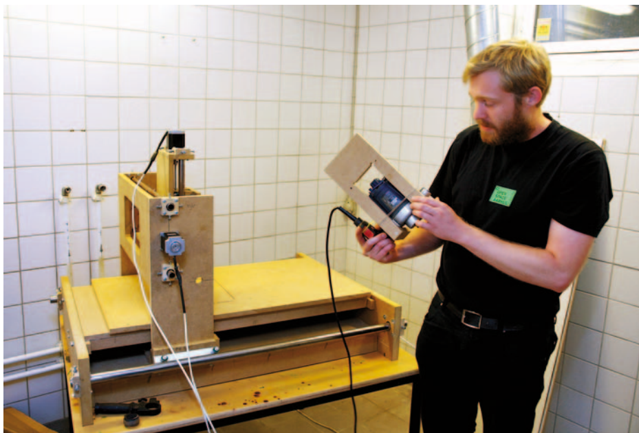
Jacob Pedersen er en af initiativtagerne til Open Space Aarhus. Her demonstrerer han sin hjemmelavede CNC-fræser, der kører på Linux og fungerer som plug and play. Den kan skære forskellige mønstre ind i træ. Foto: Søren Holm/Chili.
