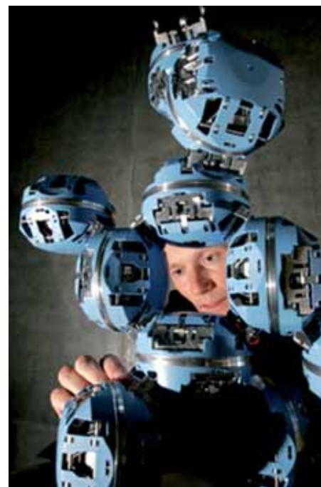
Henrik Hautop Lund kigger på sit værk: Robotten Atron, som kan ændre sin fysiske form.
