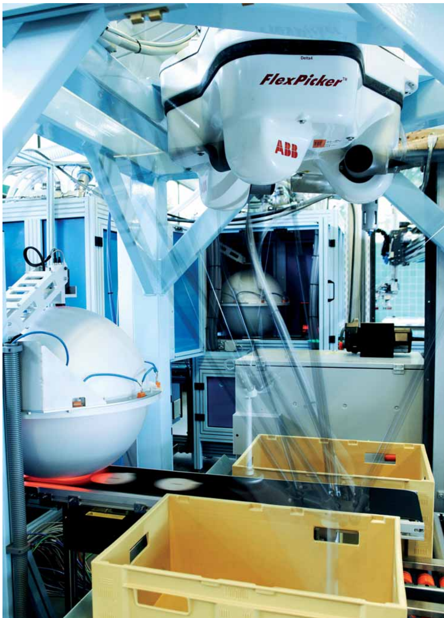
En visionstyret pakkerobot med en takt til på et sek. Foto: Prolvent
