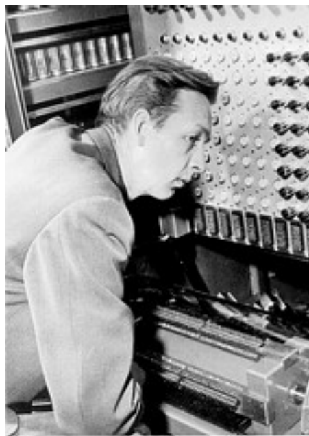
Niels Ivar Bech studerer den elektromagnetiske hukommelse i DASK.
