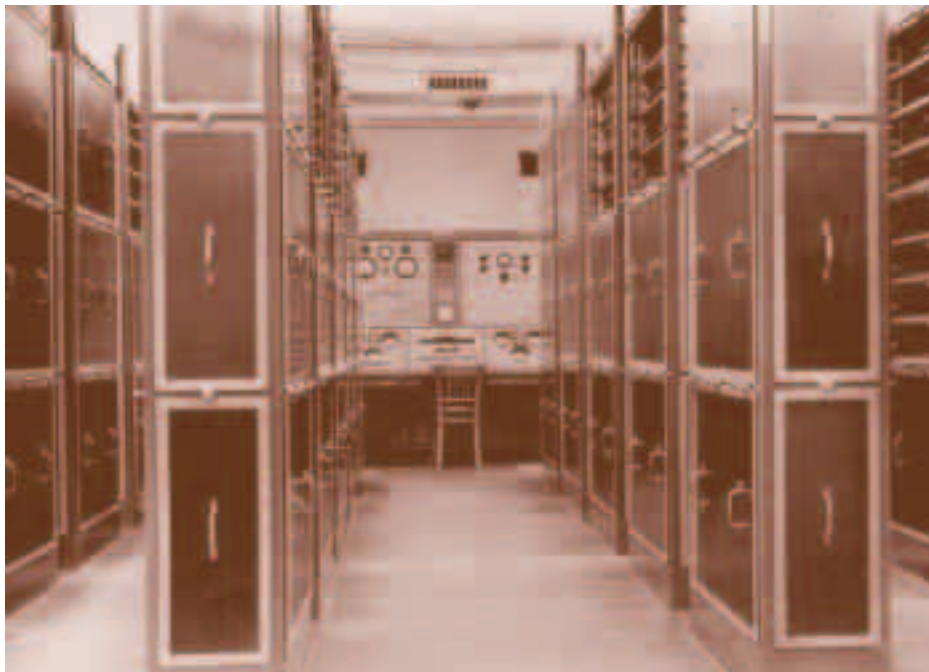
Da LEO var færdigbygget i 1951, var det verdens første computer til forretningsverdenen. Den fyldte 465 kvadratmeter og bestod af 6000 radiorør.
