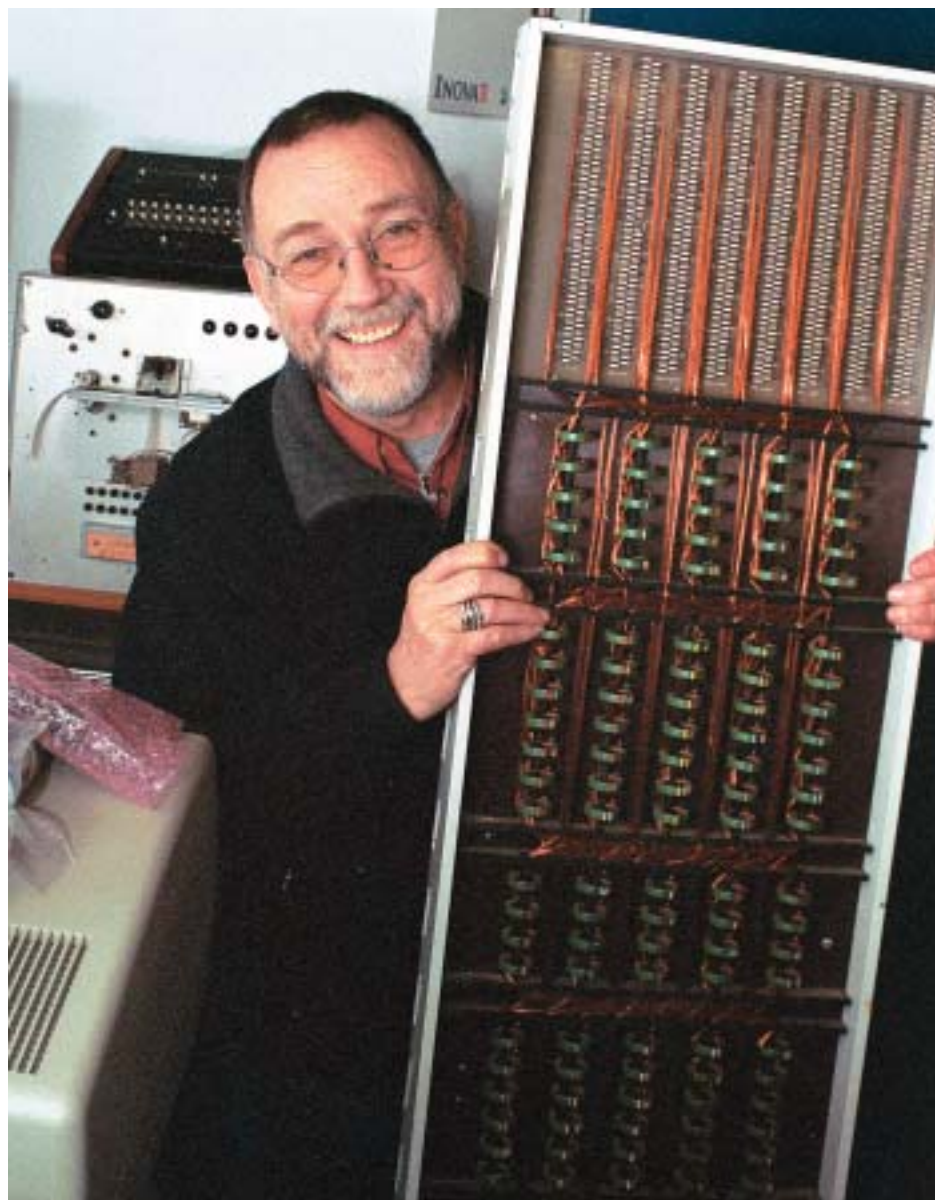
Ram-lageret fra Danmarks første serieproducerede datamaskine, Gier, er lige så højt som museumsleder Jørgen O. Bjerregaard fra Ballerup Egnsmuseum. Lageret er et ROM-lager (Read-Only-Memory) på cirka 14 kbytes, men det var så til gengæld 42 bits ord, hvor man oftest kunne have 2 ord i hver sit halvord. Lagerets består af 180 ferritringe og imellem dem aner man nogle af de 600 kobbertråde, der forbinder dem. Lageret var billigt i materialer, pålideligt og rimelig hurtigt, men dyrt at producere. Bag ham kan man lige ane selve kontrolpulten til Gier-maskinen. Foto: Claus Thorhaug.
