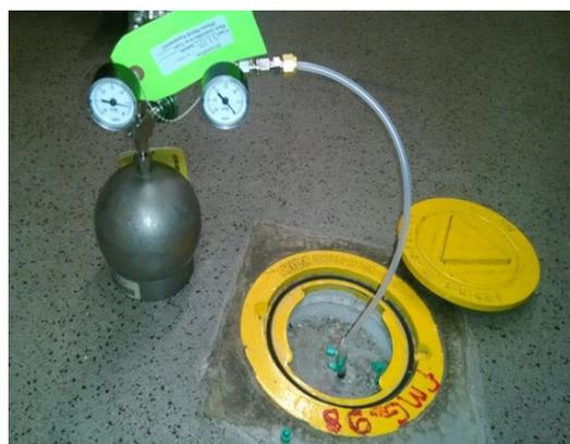
**Foto 10:** Coleta de amostra de gás para envio ao laboratório.
