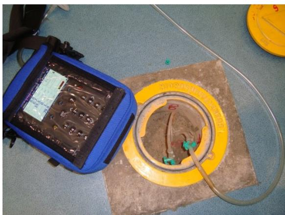
**Foto 7:** Medição de gás em poço de monitoramento - equipamento GEM 5000.
