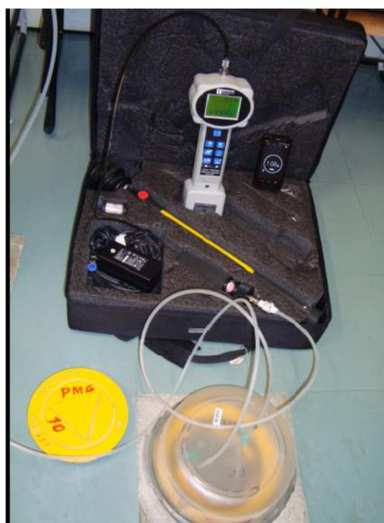
**Foto 9:** Teste de estanqueidade – poço de monitoramento PMG-10.
