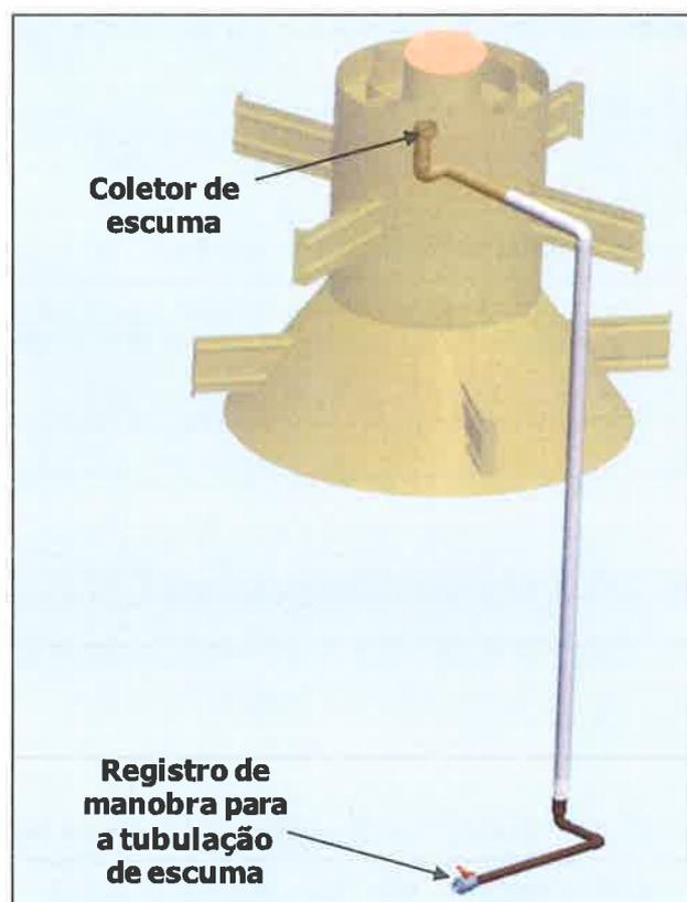
**Figura 16 – Detalhe esquemático do dispositivo para retirada de espuma**
