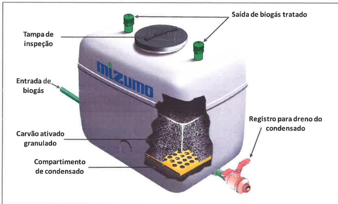
**Figura 29 - Detalhes do filtro de biogás**
