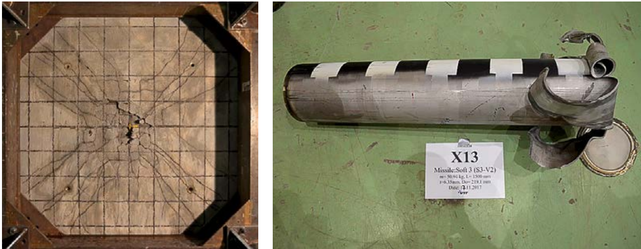
Abbildung 3: Test X13, Rissbild auf der Plattenrückseite (links) und deformiertes Projektil (rechts), Quelle: VTT
