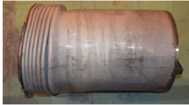
Abbildung 20: Verstärkung des Projektils im Test X12 (links) und Projektilverformung nach dem «Force plate»-Test (rechts)
