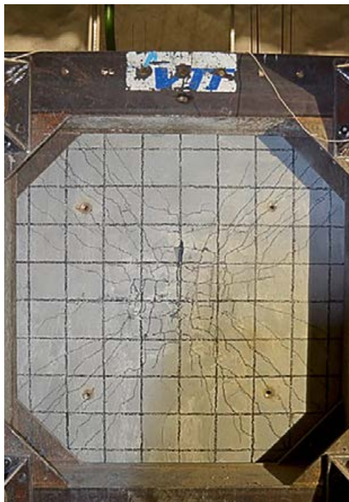
Abbildung 2: Test X12, Rissbild auf der Plattenrückseite (links), deformiertes Projektil (oben rechts) und Projektilgeometrie (rechts), Quelle: VTT
