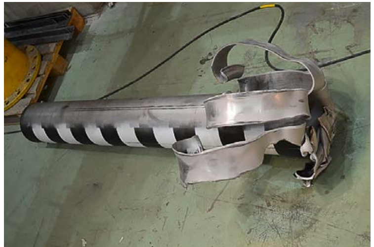
Abbildung 1: Test X11, Rissbild auf der Plattenrückseite (links) und deformiertes Projektil (rechts), Quelle: VTT
