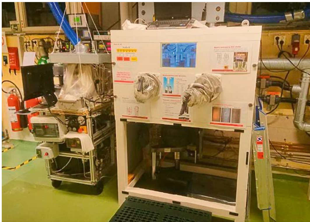
Abbildung 2: Die Anlage für die Spreizversuche (mandrel tests) im Teilprojekt 2 von SCIP-III. Auf dem Wagen links befinden sich die Einrichtungen für den Kreislauf, mit denen die chemische Umgebung während der Versuche kontrolliert wird. Quelle: Studsvik.
