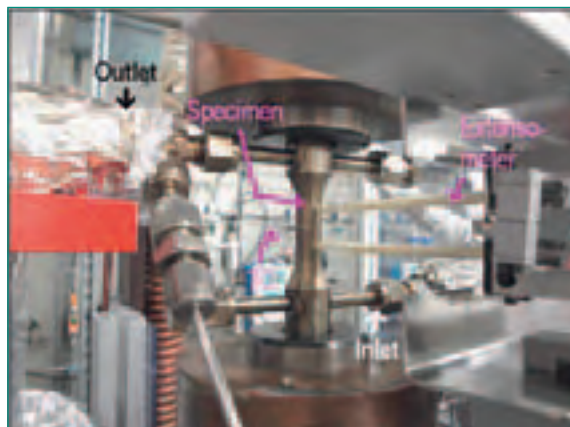
Figur 2: Anlage zur Untersuchung von durchströmten Hohlproben im PSI-Labor für nukleare Materialien. Die Probe (Specimen) wird von unten nach oben durchströmt und gleichzeitig mechanisch belastet (Quelle: PSI).
