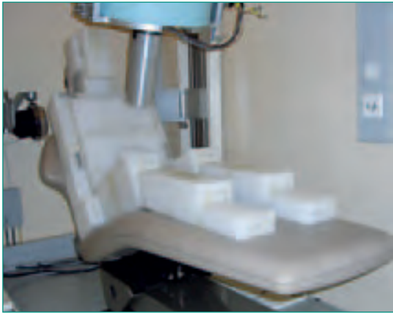
Figur 4: Messung im Ganzkörperzähler mit dem IGOR-Blockphantom, Geometrie P4.
