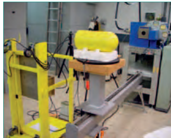
Figur 4: Prüfung der vertikalen Richtungsabhängigkeit der Hochdruckionisationskammer IG5T mit der Röntgenanlage.
