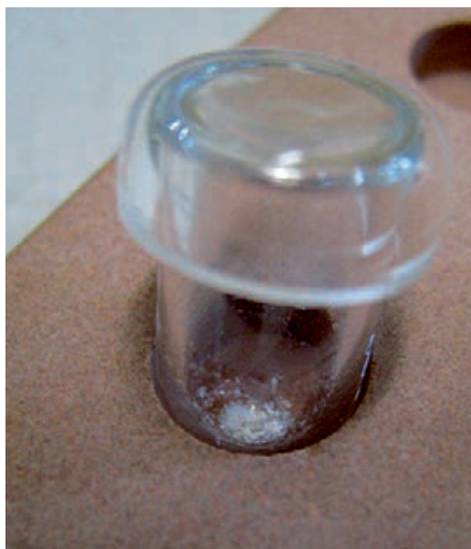
Abbildung 39: Berylliumoxid-Extrakt aus 100 g hochreinem Quarz bzw. aus ursprünglich 300 bis 400 g unaufbereitetem Probenmaterial. Durchmesser des Glas-tiegels: 5 mm, Foto: A. Dehnert.
