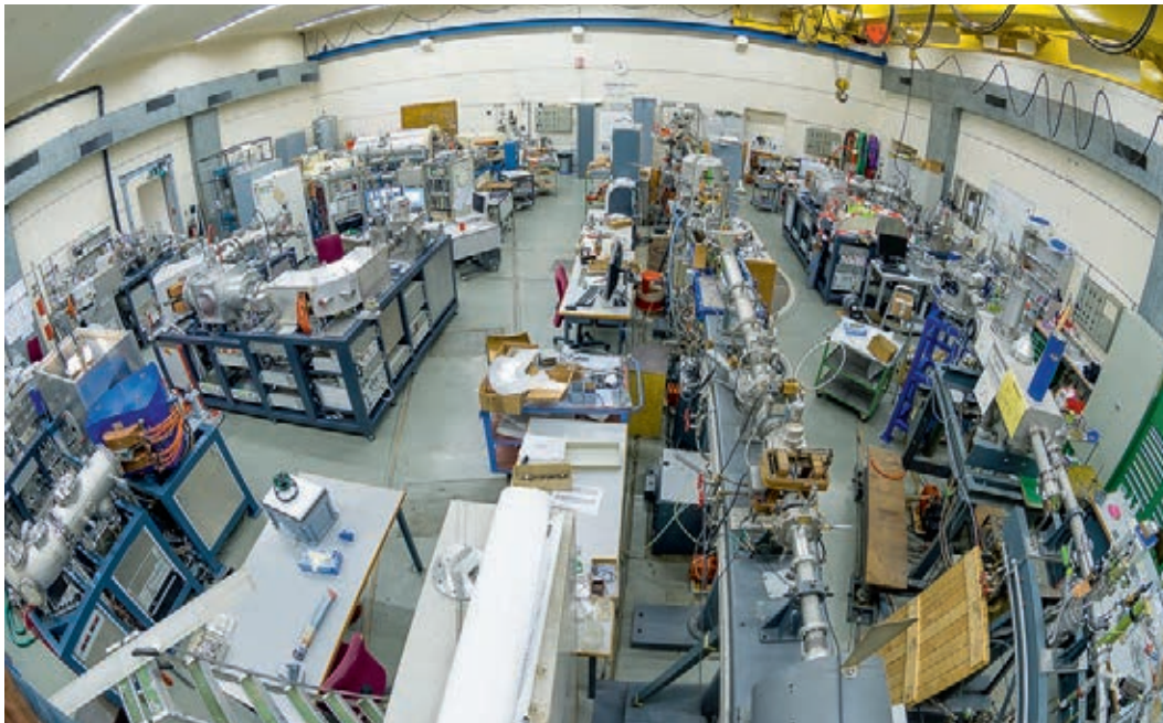
Abbildung 40: Blick in die Messhalle der Gruppe für Ionenstrahlphysik der ETH Zürich (LIP). Zu sehen sind verschiedene Messanordnungen zur Detektion unterschiedlicher Nuklide. Quelle: LIP Homepage, C. Vockenhuber ( http://www.ams.ethz.ch/instruments/index ).
