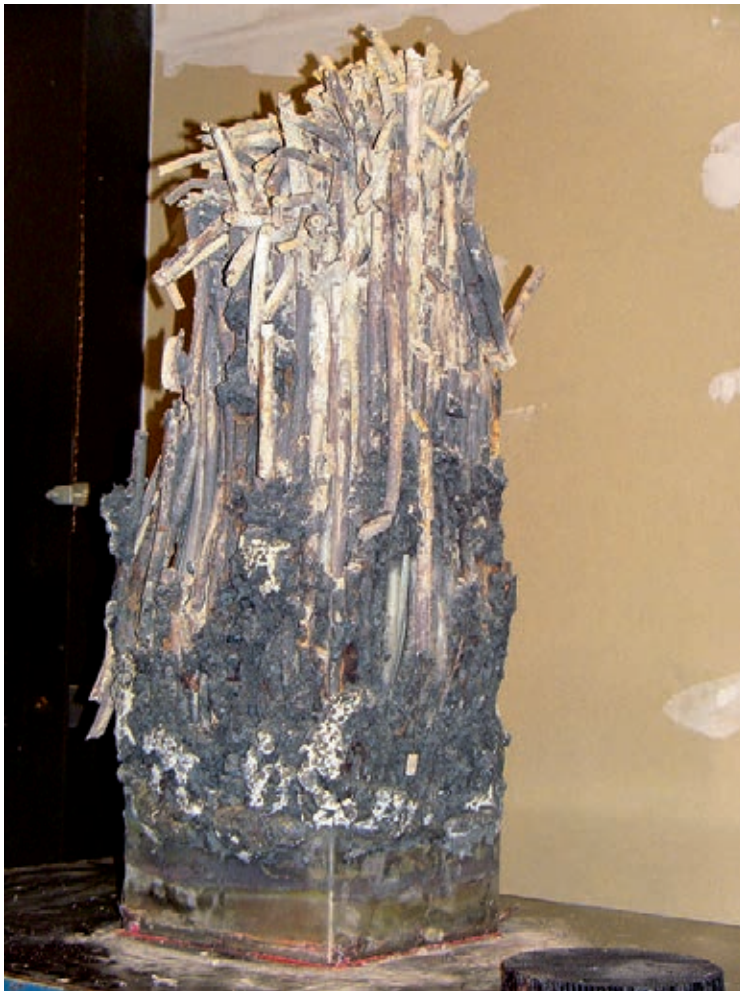
Abbildung 21: Brennelementbündel nach einem Lufteinbruch beim OECD SFP-Projekt.
