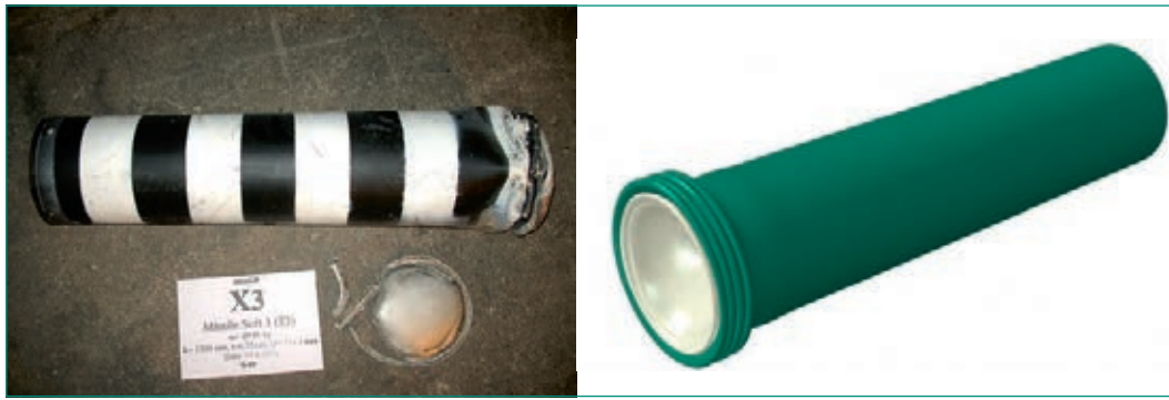
Abbildung 10: Deformiertes Projektil nach Versuch X3 (links) und aus ABAQUS-Vorbereitung (rechts).
