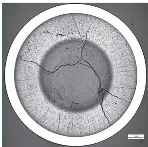
Abbildung 2: Lichtmikroskopische Aufnahme eines Schnitts durch einen Brennstab. Innerhalb der Brennstofftablette ist die für höhere Abbrände typische dunkle Zone erkennbar. Quelle: Studsvik.
