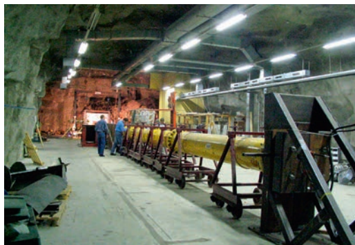
Abbildung 1: Versuchseinrichtung für Plattenbeschuss- versuche bei VTT in Espoo (Finnland)
