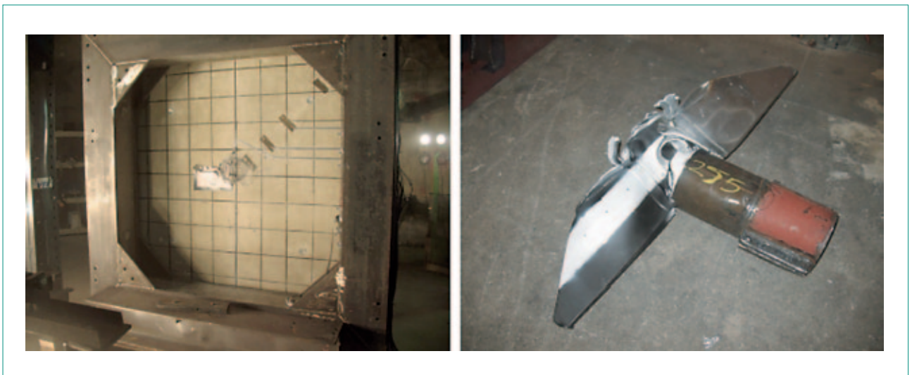
Abbildung 7: Versuchsplatte (Vorderseite) WE1A1 (links) und Projektil (rechts) jeweils nach Test.
