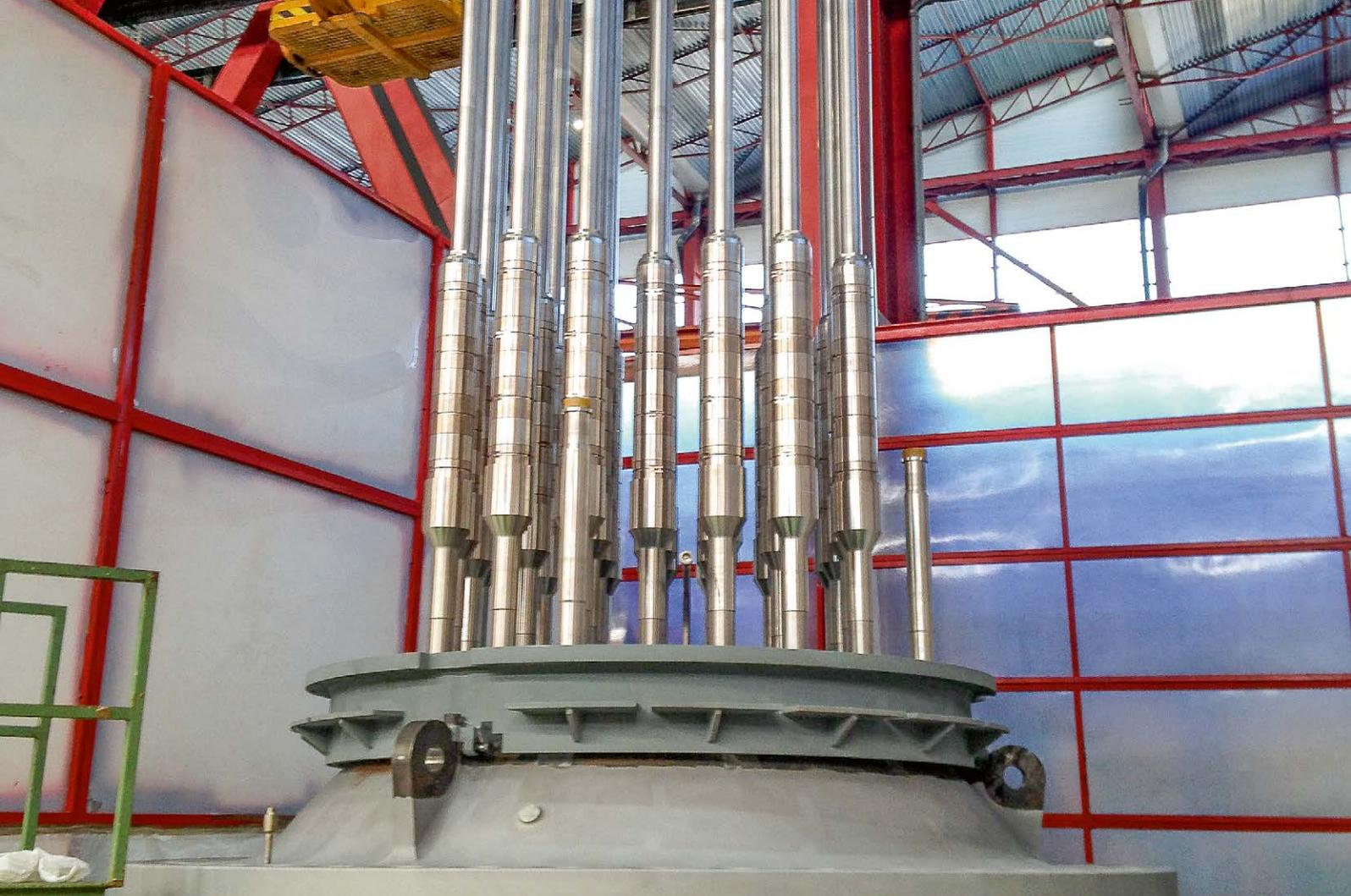
Neuer Deckel eines Reaktordruckbehälters mit Steuerstabantrieben (Bild KKB)
