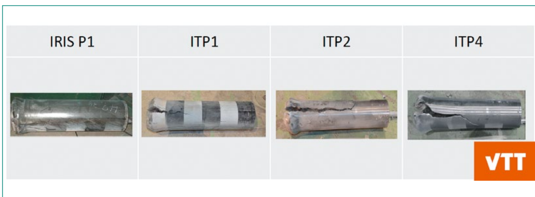
Abbildung 5: IMPACT IV – NEREID, Tests ITP1, ITP2, ITP4, Verformte Projektile, Quelle: VTT
