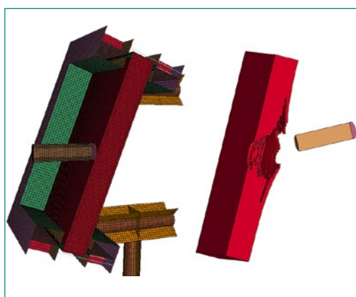
Abbildung 4: LS-DYNA-Modell des Tests IP1 (links) und berechnetes Eindringen des Projektils (rechts), Quelle: B&H, VTT
