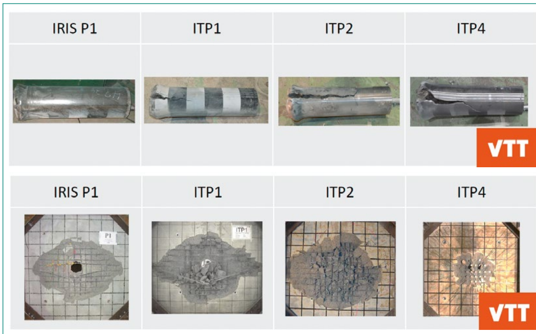
Abbildung 1: Verformte Projektile (oben) und Schädigungen auf der Plattenrückseite (unten), Quelle: VTT
