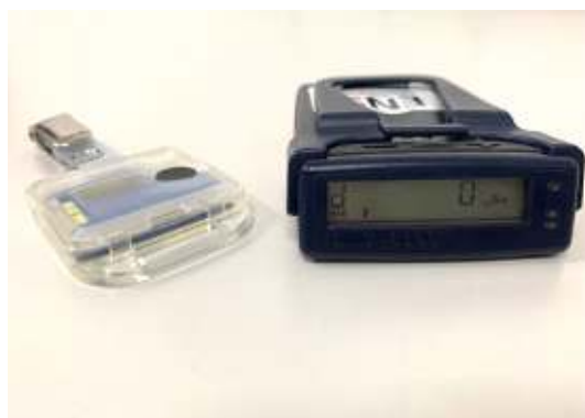
Bild 4: Personen, die bei ihrer Arbeit in Kernanlagen als strahlenexponiert gelten, müssen zwei verschiedene Dosismessgeräte tragen: Links im Bild ein passives Dosimeter, rechts ein aktives Dosimeter.
