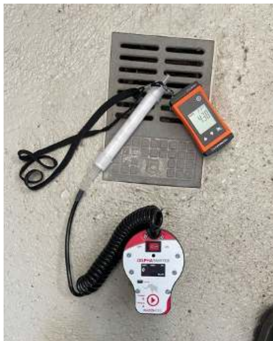
Bild 1: Messanordnung eines Radontec-Alpha-Sniffer-Messgeräts zur Radonaktivitätsbestimmung und eines CO 2 -Monitors.
