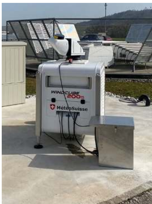
Bild 21: Messstation Payerne von MeteoSchweiz mit Doppler-LIDAR im Vordergrund und Windprofiler im Hintergrund. (Quelle: MeteoSchweiz)
