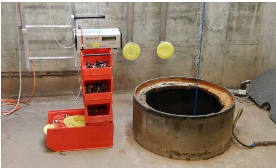
Bild 2: Radon-Screening-Messung bei einer Grundwasserfassung in einem KKW.
