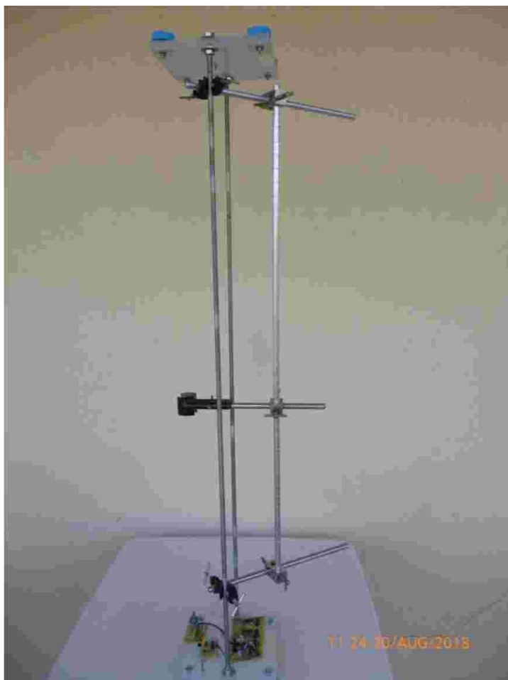
Σχήμα 3: Το εκκρεμές με το ηλεκτρονικό κύκλωμα που παράγει παλμούς της ίδιας συχνότητας με τη συχνότητα των ταλαντώσεών του. Διακρίνονται επίσης ο μετρητικός ορθοστάτης (στα δεξιά) και ο δίσκος (στο κέντρο) μέσω του οποίου περνάει το νήμα.
