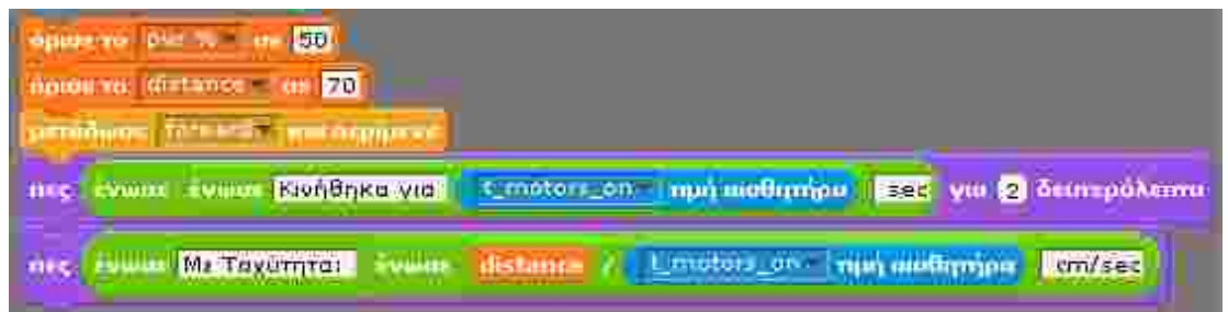
Σχήμα 10. Πρόγραμμα υπολογισμού ταχύτητας. Εκτελείται για τις ίδιες τιμές ισχύος ( pwr\% ) και απόστασης ( distance )
