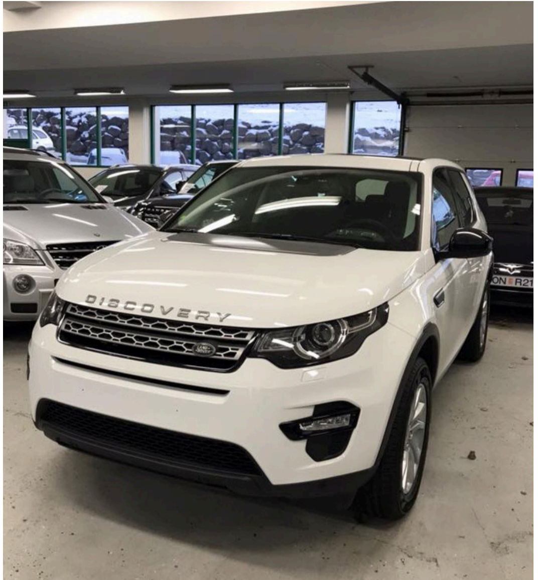
Þessi 2017 Land Rover Discovery Sport fékk aflaukningu og fór úr 150 hestöflum í 180 hestöfl og togð fór úr 380nm í 440nm. Einnig er eyðslan að fara niður um allt að 10%.
