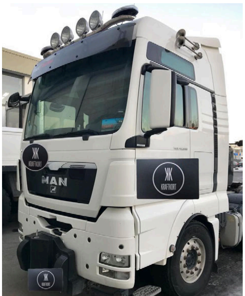
Þessi 2013 MAN TGX 540 fékk aflaukningu ásamt því að AdBlue var tekið út. Hann fór úr 540 hestöflum í 620 hestöfl og togð fór úr 2450nm í 2850nm. Einnig er eyðslan að fara niður um allt að 13%.
