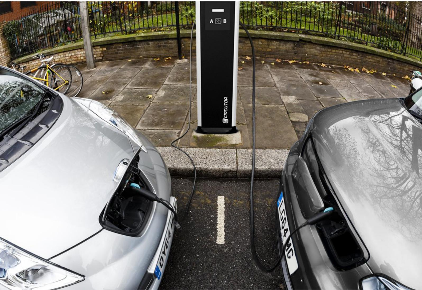
Die Ladesäulen URBAN sind für die Aufladung an Parkplätzen im Freien gedacht, an denen ein robustes und gleichzeitig ansprechendes Gerät gewünscht ist. Sie verfügen über alle erforderlichen elektrischen Schutzvorrichtungen nach dem geltenden Verbraucherschutzgesetz.
