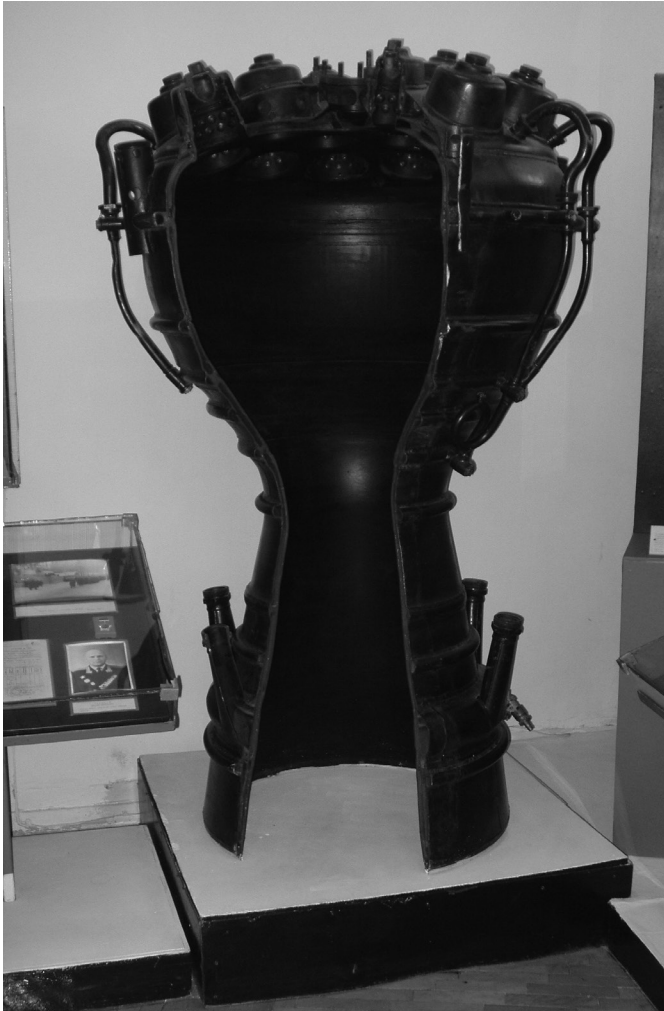
Рис. 7. Камера сгорания жидкостной одноступенчатой ракеты Р-2 (Экспонат).
