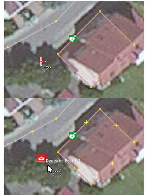
Abbildung 17: Zweimal auf dieselbe Stelle klicken (oben) erzeugt einen einzelnen Node. Tagging dran, fertig ist der Briefkasten. Oder der Defibrillator.
