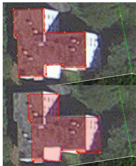
Abbildung 30: Bei perspektivisch aufgenommenen Gebäuden nicht die Dächer mappen (oben), sondern die Grundflächen (unten) – bei solchen Klotzhäusern mit Flachdächern ist das meist über eine simple Verschiebung machbar, weil Grund- und Dachfläche kongruent sind.
