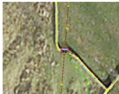
Abbildung 24: Ein Feldweg (braun) quert eine Mauer (gelb) durch ein Tor. Das Tor gehört als shared node sowohl zur Mauer als auch zum Weg. Fußgänger dürfen das Tor passieren, daher muss unbedingt **foot=yes** an den Tor-Node getaggt werden!
