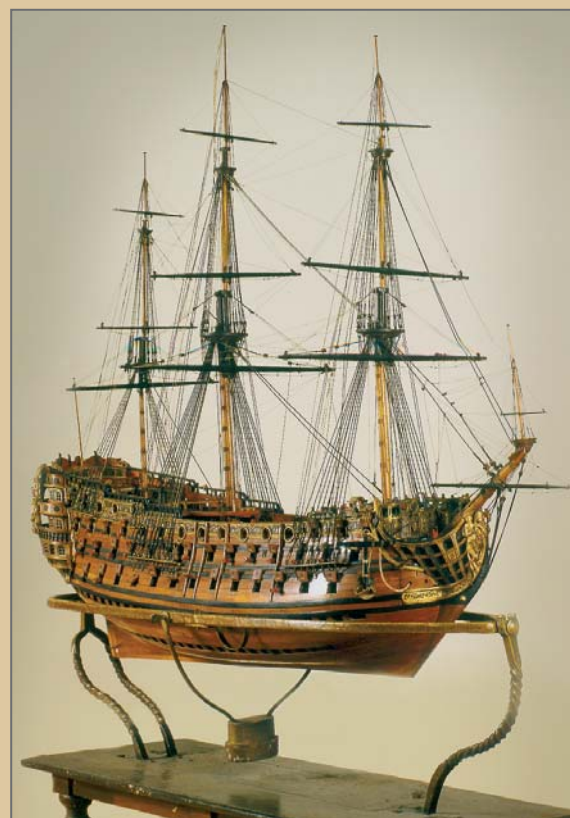
Модель 100-пушечного корабля I ранга «Ройал Джордж» Великобритания. 1715 год Принадлежала Петру I. Модель закреплена на конструкции, позволяющей имитировать положение корабля при качке Model of the 100-gun 1st rank ship Royal George Great Britain 1715 Belonged to Peter I. The model is attached to an arrangement that allows imitation of ship rolling
