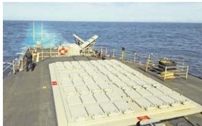
Корабельные установки вертикального пуска Mk 41, используемые США и для наземной системы ПРО на территории Польши и Румынии, способны применять не только противоракеты, но и крылатые ракеты «Томагавк».
