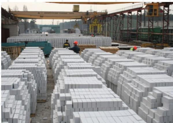
Блоки стеновые из ячеистых бетонов ГОСТ 21520. Размеры: 50\*288\*600 100\*288\*600, 150\*288\*600, 200\*288\*600; 250\*288\*600, 300\*288\*600, 350\*288\*600, 400\*288\*600.
