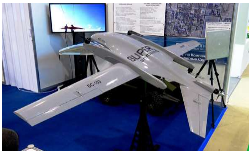
Рисунок 1 – Беспилотные самолёты вертикального взлёта и посадки в ряде случаев могут заменить коптеры, а также самолёты с катапультно-парашютной взлётно-посадочной системой
