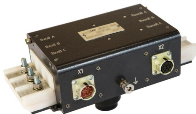
Рисунок 2 – Управляемое коммутационное устройство.
