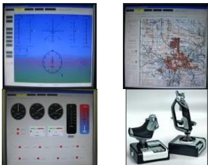
Рисунок 5 – Рабочее место оператора: пилотажный экран; маршрутная карта; панель состояния систем вертолёта; джойстики управления вертолётном.
