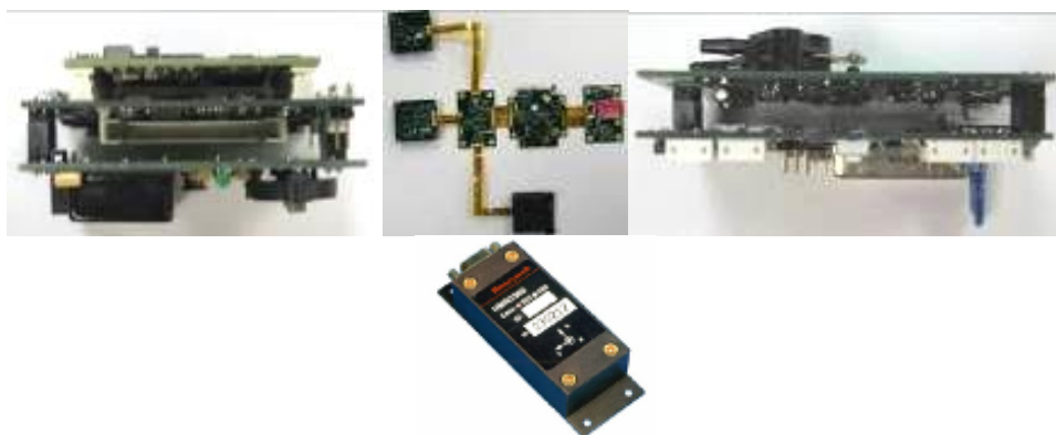
Рисунок 4 – Бортовой комплекс управления: блок вычислителя со спутниковым навигационным приёмником; блок чувствительных элементов бесплатформенной инерциальной навигационной системы; блок измерения воздушных сигналов; магнитометр
