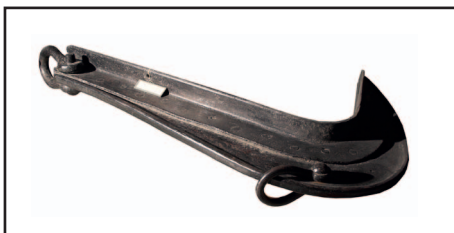
58. Ледовый якорь ледокола «Ермак», 1898 Чугун. 176 x 105 x 22 см Инв. № 10 МП-1100; КП-41030
