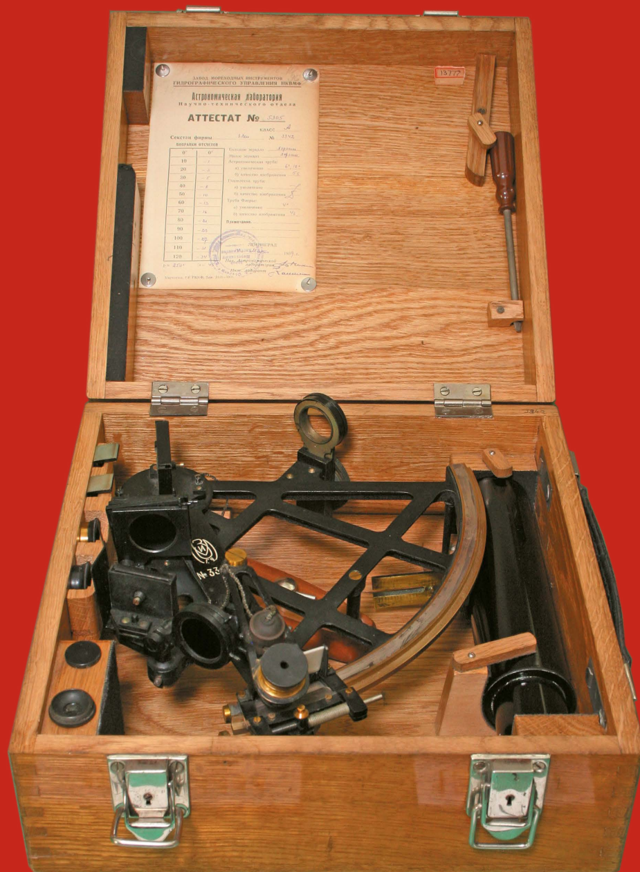
Секстан навигационный образца 1932 года Завод мореходных инструментов, Ленинград. 1939
