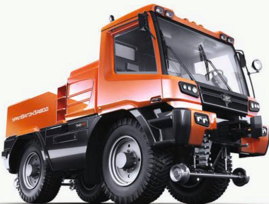
Универсальное транспортное средство рамной конструкции с двумя ведущими мостами, с управляемыми передними и задними колесами, с передними и задними направляющими железнодорожными колесами.
