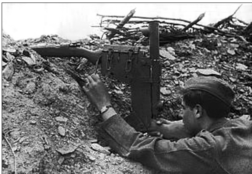
Фото № 1. Приспособление для стрельбы из укрытия из немецкой самозарядной винтовки G-41 (W)
