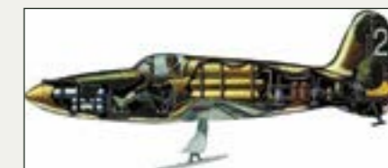
Внутренняя конструкция БИ-1
