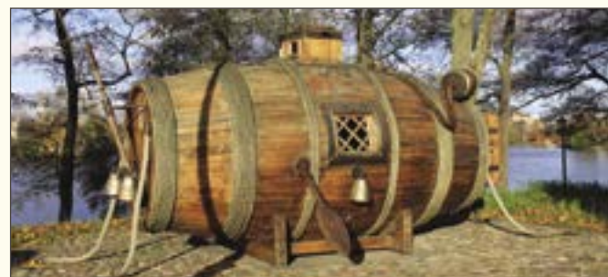
Макет-реконструкция в натуральную величину «потаённого судна» — первой русской подводной лодки Е.П. Никонова в Сестрорецке
