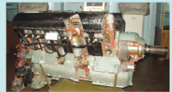
Двигатель М-34PNA (конструктор А.А. Миклушина)
