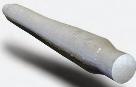
ЧЕРНОВЫЕ ОСИ ИЗГОТОВЛЯЮТСЯ НА АВТОМАТИЗИРОВАННОЙ РАДИАЛЬНО-КОВОЧНОЙ МАШИНЕ SHP-32 ИЗ МАРТЕНОВСКОЙ ИЛИ НЕПРЕРЫВНОЛИТОЙ СТАЛИ
