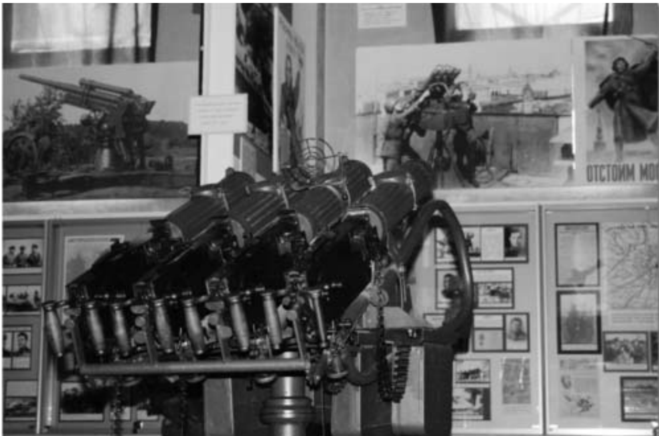
Счетверенная зенитная установка образца 1931 г. на базе станкового пулемета системы «Максим»
