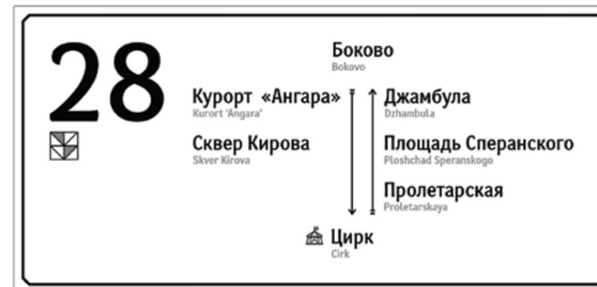
Таблички выполняются методом полноцветной УФ-печати на каландрированной ПВХ пленке разрешением не менее 1440 dpi, с последующим нанесением на листовую материал А-ПЭТ ZENOPET (или аналоги), прозрачный, толщиной 1 мм. Монтаж к поверхности осуществляется с использованием двусторонней клейкой ленты 3M 92015, прозрачной, с высокой адгезией.
