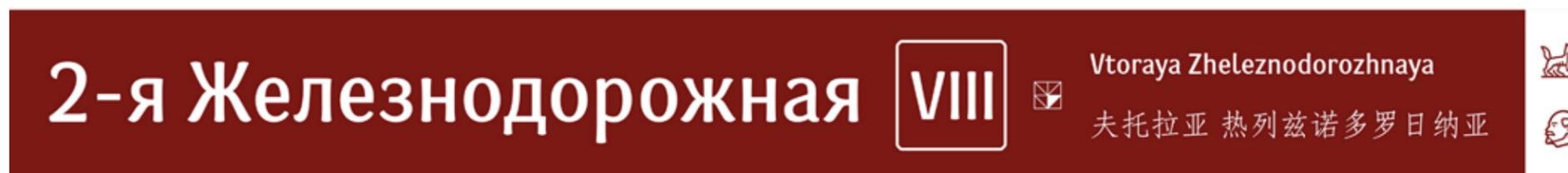
Вывеска выполняется методом аппликации из белой виниловой ПВХ пленки с последующим нанесением на листовый композитный материал, окрашенный в массу, толщиной 3 мм. Монтаж к поверхности осуществляется с использованием дистанционных держателей Д12-22м (или аналоги), либо к подготовленной поверхности, возможно обрамление металлическим, нержавеющей профилем.
