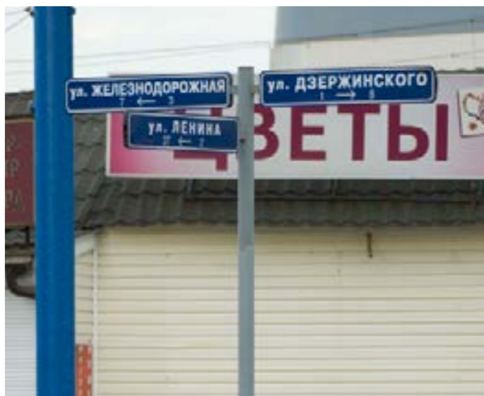
Рис. 75. Пешеходный указатель в Подмоскowie. Ориентирует по нахождению улиц и подсказывает, в какую сторону увеличивается нумерация домов. Цвет указателей рифмуется с цветом табличек на домах с названиями улиц и номерами домов.
