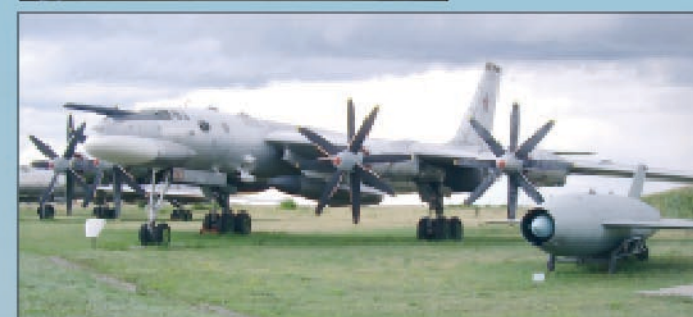
▲ Ту-95К-22 с подвешенной крылатой ракетой Х-22. Рядом – первая отечественная стратегическая крылатая ракета Х-20
