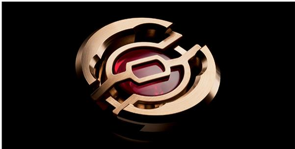
Afin d'accroître la résistance de ses mouvements en cas de choc, et notamment de chute, Rolex a mis au point et fait breveter un amortisseur de chocs très efficace qui protège les composants sensibles du mouvement, comme l'axe de balancier : le Paraflex. L'amortisseur de chocs Paraflex accroît de 50 % la résistance aux chocs.
