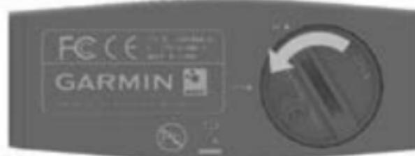
2. С помощью монетки поворачивайте крышку против часовой стрелки и затем снимите ее (стрелка должна быть направлена на **OPEN**).
