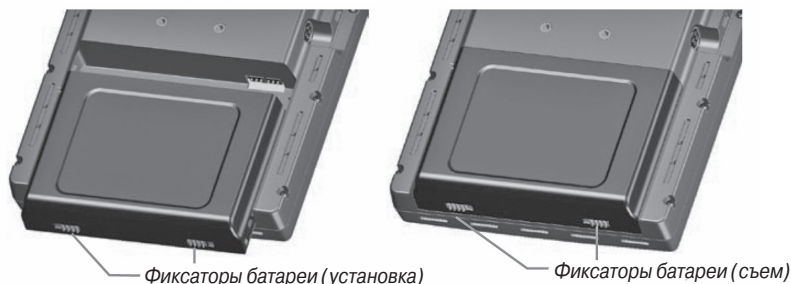
Установка батарейного блока
