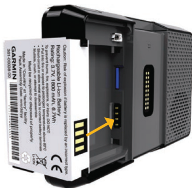
Рис.: Установка батареи.
