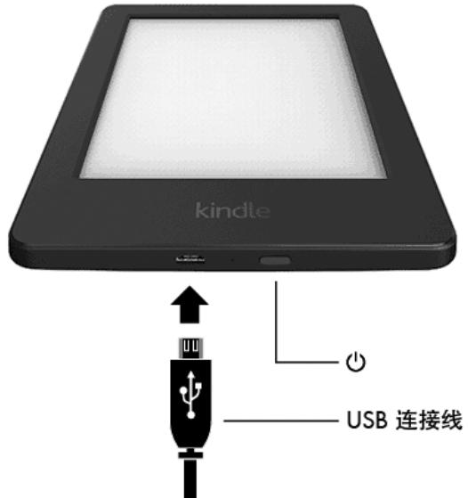
**电源开关：**按下 Kindle 电源开关以打开您的 Kindle。如需关闭 Kindle 屏幕，请按住电源开关 7 秒直至【电源】对话框出现，然后选择【关闭屏幕】。
