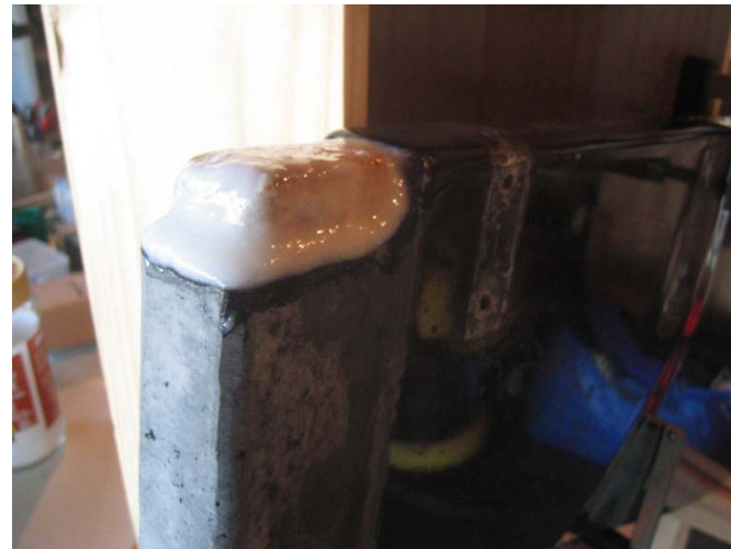
Mise en place du noyau et collage (résine époxy + fibrette + \mu sphères de verre + silice colloïdale )
