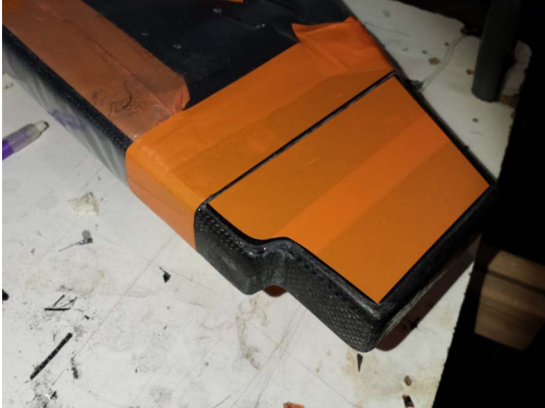
Masquage pour mise en place d'une bande de carbone supplémentaire sur face AV et talon et sur face AR
