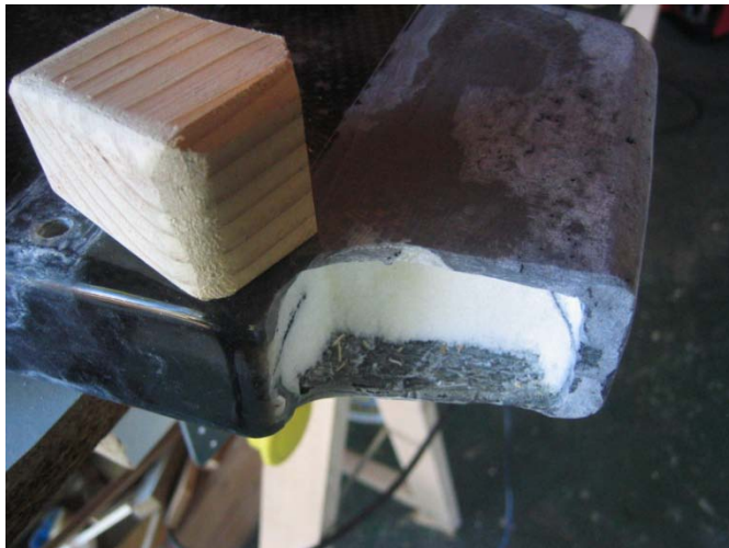
Mise en place du noyau et collage (résine époxy + fibrette + \mu sphères de verre + silice colloïdale )
